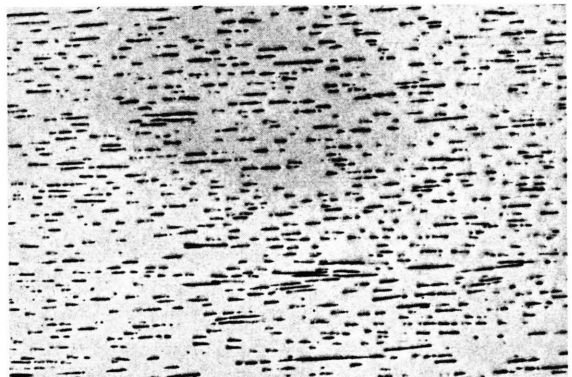
Abb. 11. Ungestörtes, geordnetes Gefüge eines Barrens, der unter Bedingungen des Versuches IV kristallisierte; Vergr. 150 \times .
